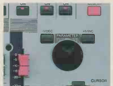
Parameter dial and inc/dec buttons
