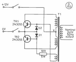
Fig. 1 CIRCUIT OF 240V 50Hz INVERTER
