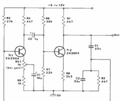
Fig 4 Practical 1kHz Wien oscillator
