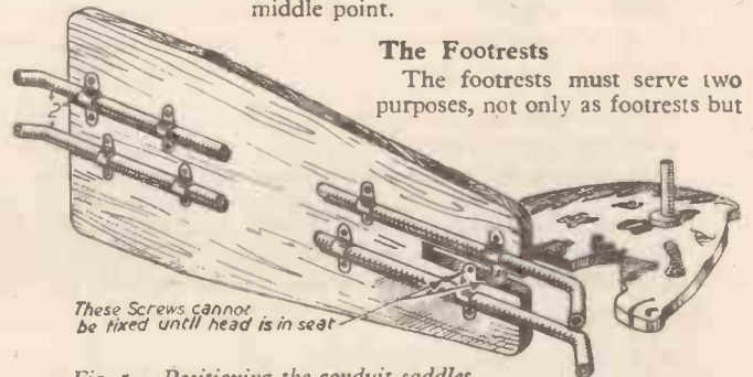
Fig. 5.—Positioning the conduit saddles.
