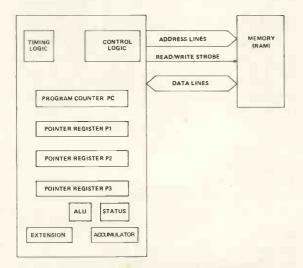
FIG. 1. SC/MP SYSTEM BLOCK DIAGRAM
