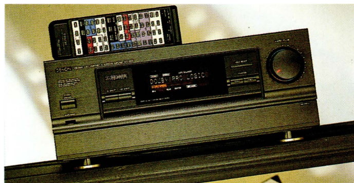
Denon's new top dog AV amp, the AVC-3530, uses a PMI Dolby chip.
