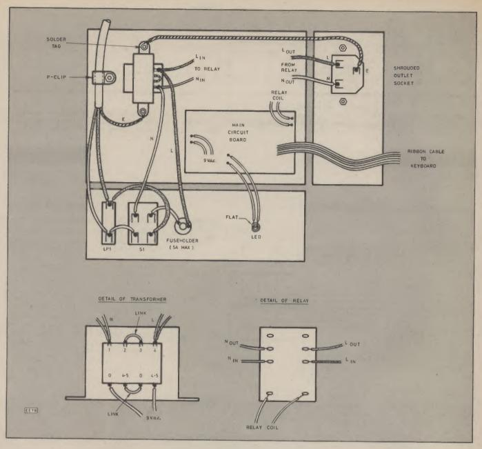
Fig. 8. Codelock wiring diagram.
