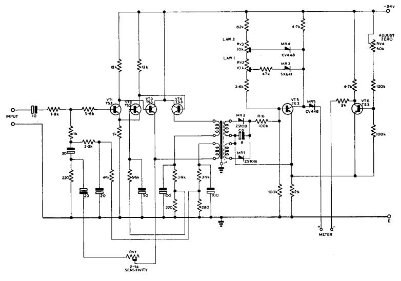
Fig. 4 — Programme Meter Amplifier: Circuit
