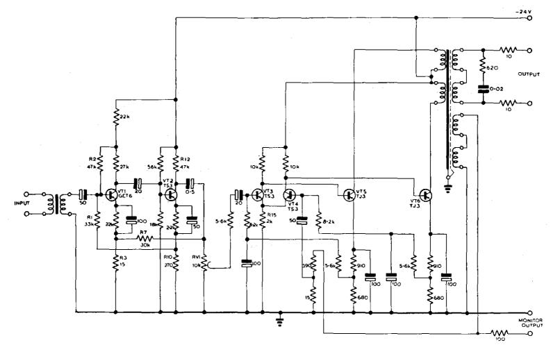
Fig. 3 — O.B. Amplifier: Circuit
