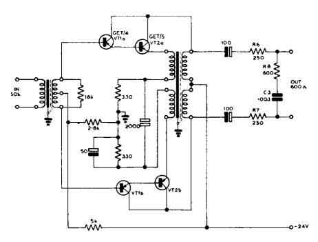
Fig. 6 — Line-sending Amplifier: Circuit
