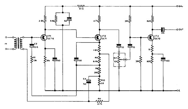
Fig. 5 - Microphone Pre-amplifier: Circuit
