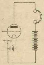
Fig. 1 .- Anode Circuit of Note Magnifier.
