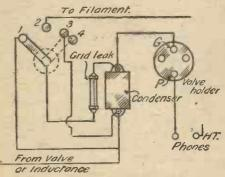
Fig. 1 .- The Complete Detector.
