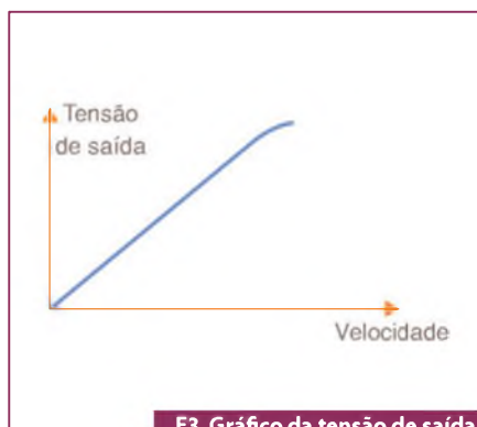
F3. Gráfico da tensão de saída x velocidade, num tacogerador.
