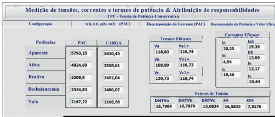
F6. Tela do instrumento virtual mostrando a decomposição da potência calculada a partir das tensões e correntes medidas (PAC) e calculadas segundo a proposta de tarifação dos autores da TPC (CARGA).
