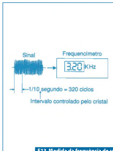
F13. Medida da frequência de um sinal com um freqüencímetro.
