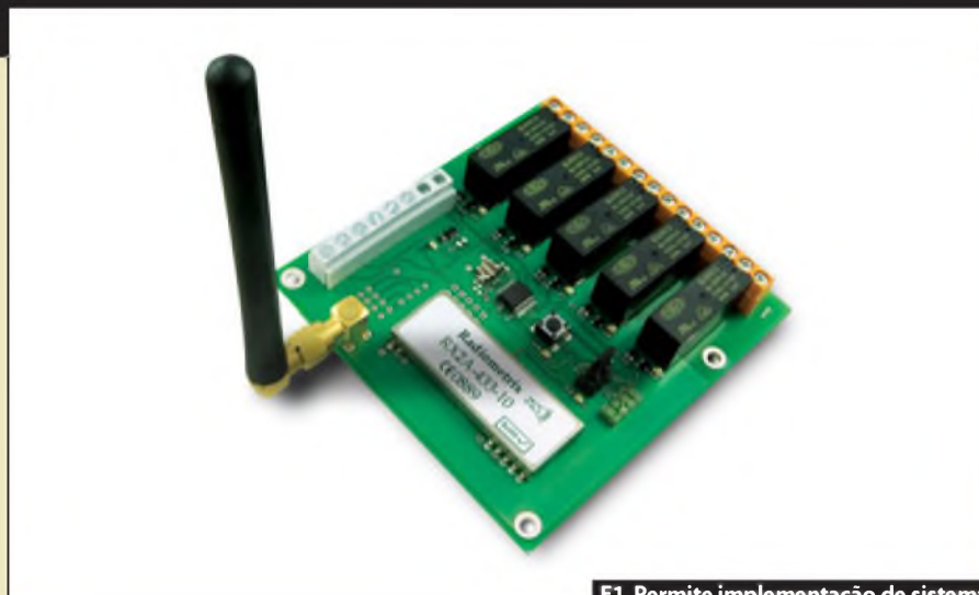
F1. Permite implementação de sistemas seguros de controle remoto via RF.
