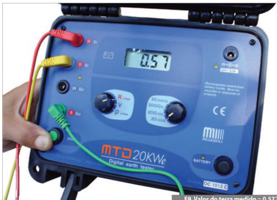
F9. Valor do terra medido = 0,57 \Omega .
