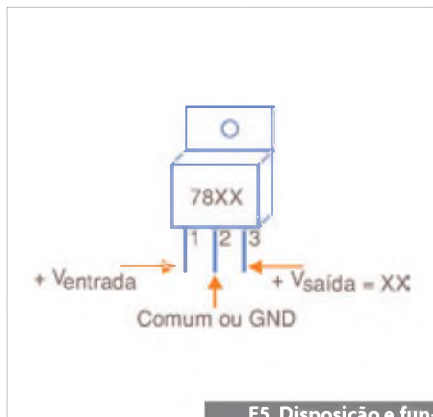
F5. Disposição e função dos terminais.
