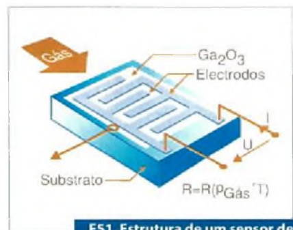
F51. Estrutura de um sensor de gás por semicondutor Siemens
