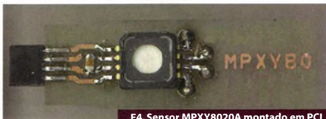
F4. Sensor MPXY8020A montado em PCI
