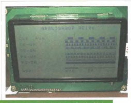
F4. Imagem do display do analisador lógico
