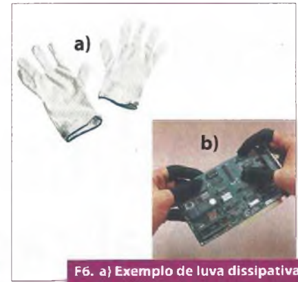
F6. a) Exemplo de luva dissipativa e b) Dedeira dissipativa.
