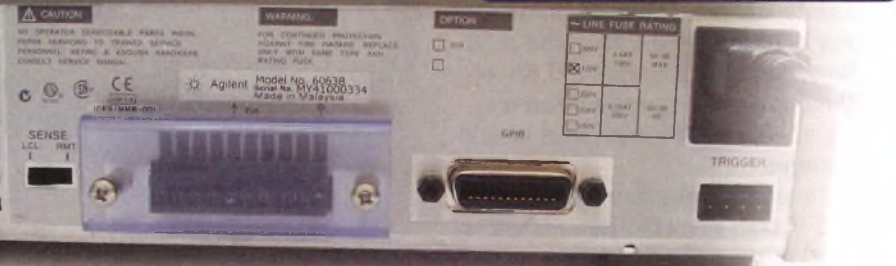
Figura 7b - Interface GP-IB no painel traseiro. Integração com sistemas automatizados de testes.
