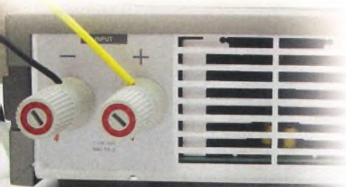
Figura 2 - Detalhe dos terminais de conexão da carga eletrônica
