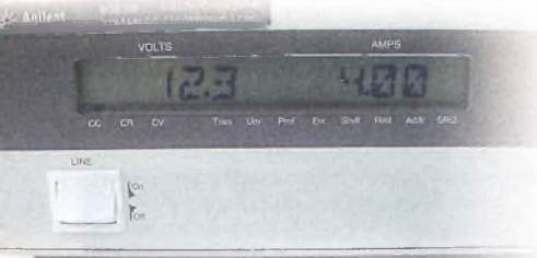
Figura 3 - Display da carga eletrônica mostrando os valores instantâneos de tensão e corrente.
