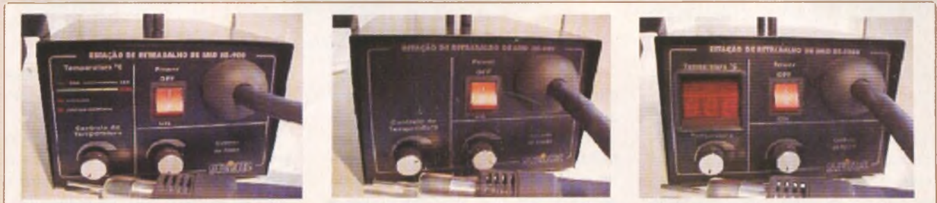
Figura 11 - Estações de retrabalho da Steinel – para soldagem e dessoldagem de componentes SMD.
