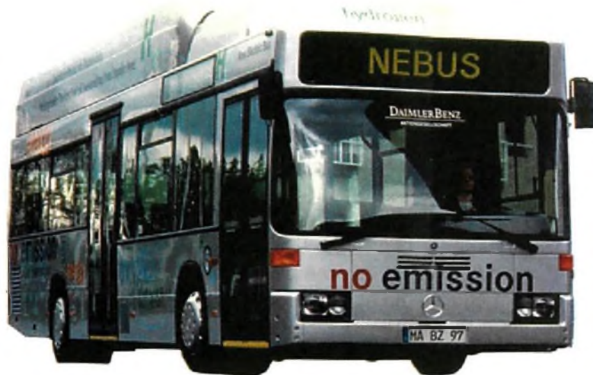
O NEBUS da Mercedes-Benz que utiliza células a hidrogênio com 250 kW de potência sem poluição alguma.
