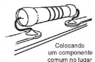
Fig. 6 - Substituindo um componente SMD.
