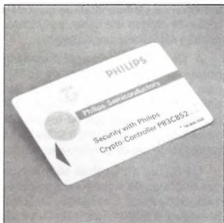
Cartão inteligente com microcontrolador Philips
