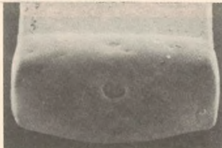
Fig. 8.2(b): SMD sem terminal - soldabilidade aceitável, menos de 5% da área não está umedecida.
