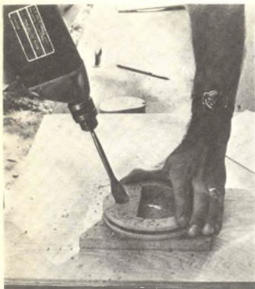
Fig. 6 - Con una meccia si pratici il foro per il manico, facendo in modo che risulti inclinato di circa 18° rispetto al taglio a D.
