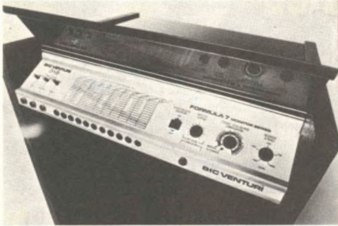
Pannello di controllo del sistema della B.I.C., modello Formula 7. La carta sporgente facilita l'interpretazione degli indicatori di livello sonoro.
