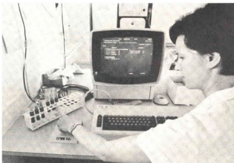
Identificazione dei campioni secondo le istruzioni date dall'elaboratore centrale IBM. Sul video compare la lista delle apparecchiature necessarie per effettuare le analisi; il tecnico registra magneticamente sulla provetta i dati del paziente controllandone l'esattezza sul piccolo visore.
