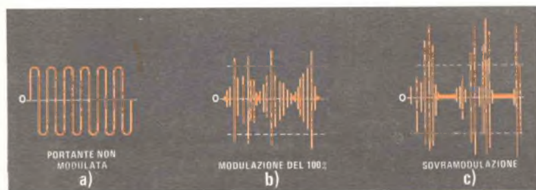
Fig. 2 - Immagini ottenute sull'oscilloscopio con diverse profondità di modulazione. I tratti rettilinei orizzontali che compaiono nell'immagine c) rivelano che si stanno generando forti interferenze sui canali vicini.
