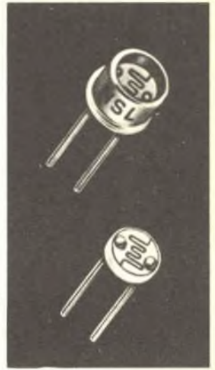
Fig. 2 - Cellule fotoconduttive della National Semiconductor e grafici dei responsi spettrali.
