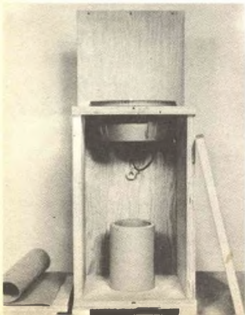
Fig. 4 - L'altoparlante è rivolto verso l'alto, mentre la morsetteria ed il controllo del tweeter sono montati nella parte posteriore.
