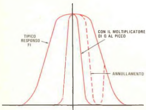
Fig. 2 - Le forme d'onda mostrano l'effetto di un moltiplicatore di Q sul responso FI di un ricevitore di prezzo medio.
