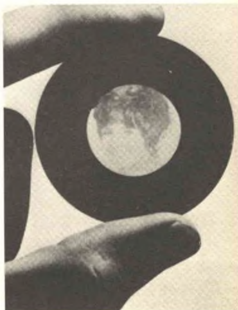
Fig. 7 - Questa immagine fotografica immagazzinata in un Ceramic della Sandia è pronta per essere proiettata come una diapositiva.
