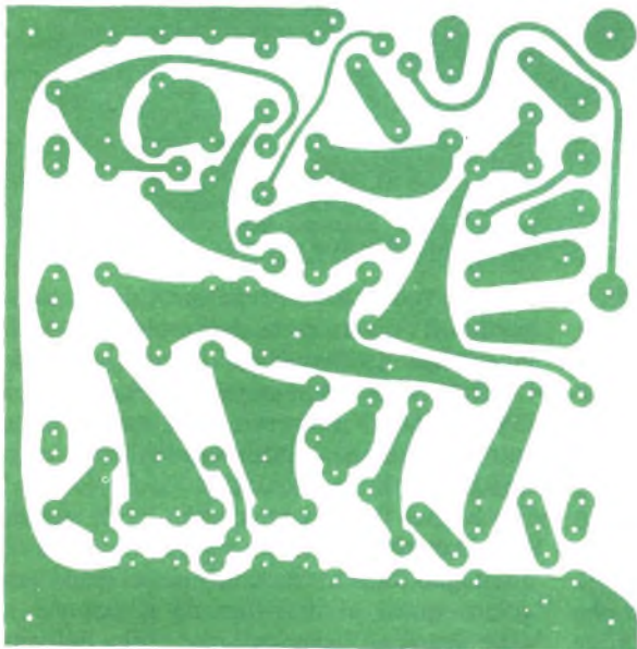
Fig. 2 - Circuito stampato in grandezza naturale (a sinistra) e disposizione dei componenti (sotto). Il circuito stampato si fissa su quattro distanziatori e l'alimentatore si monta in un luogo conveniente della scatola. Il dispositivo può anche essere montato in un amplificatore già esistente, con gli interruttori di controllo facilmente accessibili.
