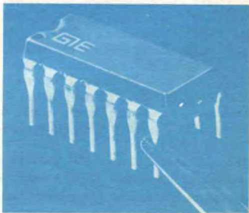
Fig. 5 - Nuovo shift register dinamico DL-7-1512 a 512 bit, in contenitore plastico, della General Instrument.
