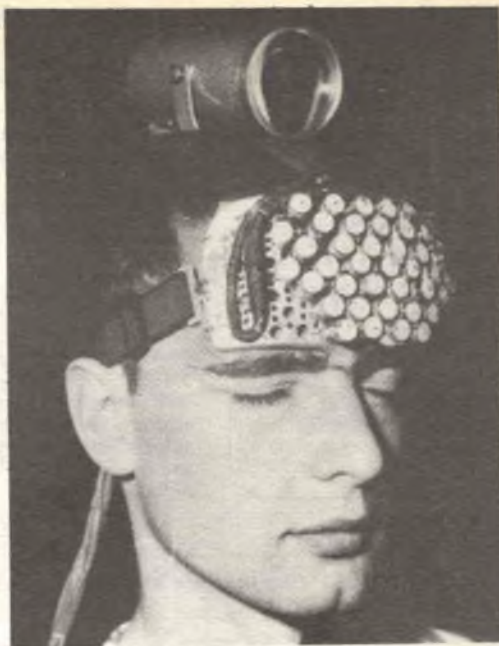
Nell'Elektrotalm, recentemente costruito in Polonia, la vista viene sostituita dal tatto. L'immagine è scandita da una camera fotoelettrica sulla testa del cieco e proiettata sulla fronte. La visione è rudimentale.
