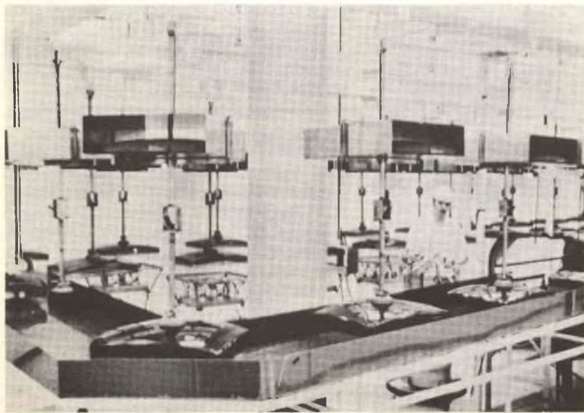
Fig. 1 - Una sezione della sala schermi dove i pannelli vengono lavati automaticamente quando si trovano ancora sul convogliatore. Questa operazione precede il caricamento degli schermi sulle catene per l'applicazione automatica dei fosfori ai pannelli di vetro.
