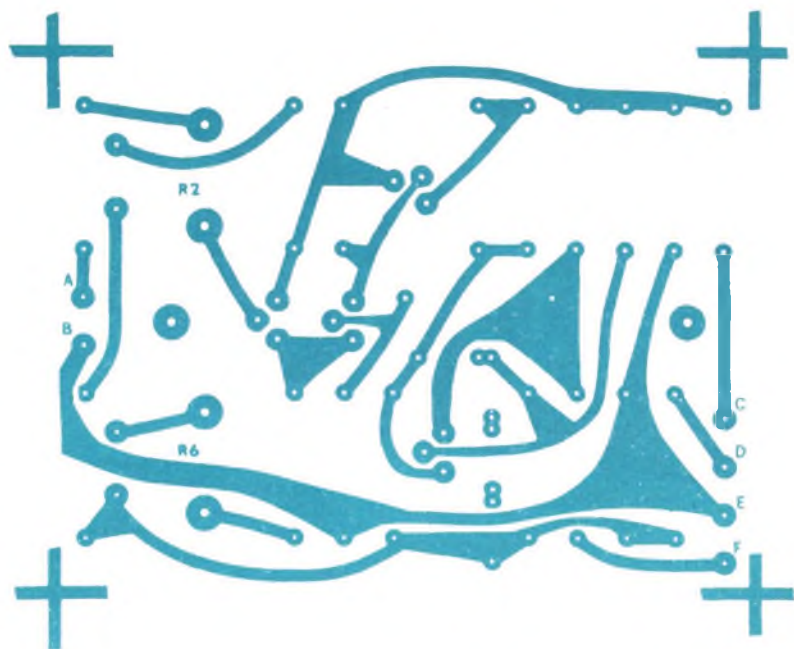
Fig. 2 - Circuito stampato in grandezza naturale. I segni ai 4 angoli indicano le dimensioni della basetta. I due fori di montaggio si trovano lungo la linea centrale.
