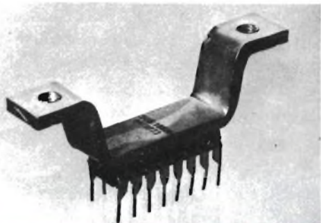
Fig. 6 - Esempio dei nuovi circuiti integrati lineari realizzati recentemente dalla S.G.S.
