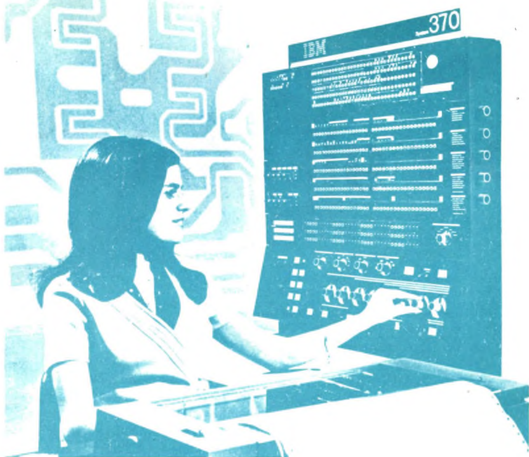
L'unità centrale del Sistema/370 IBM Modello 155.
