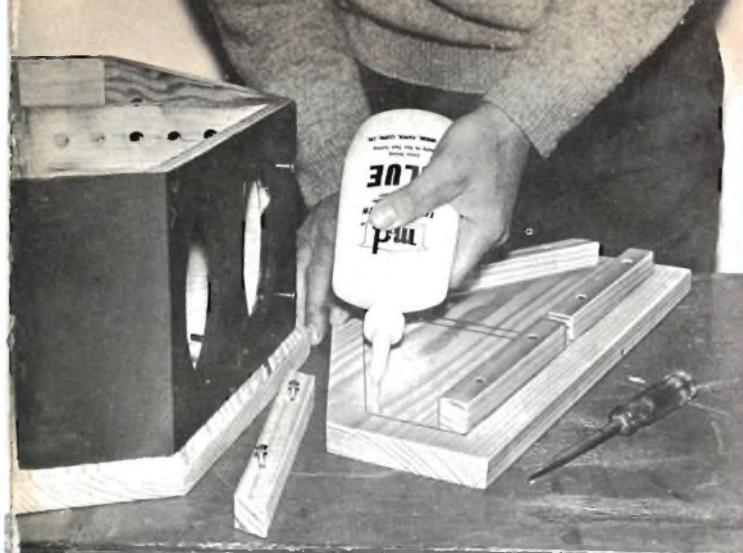
Fig. 4 - Lungo le linee tracciate sul pannello superiore, fissate le traversine, lasciando spazio per il separatore.
