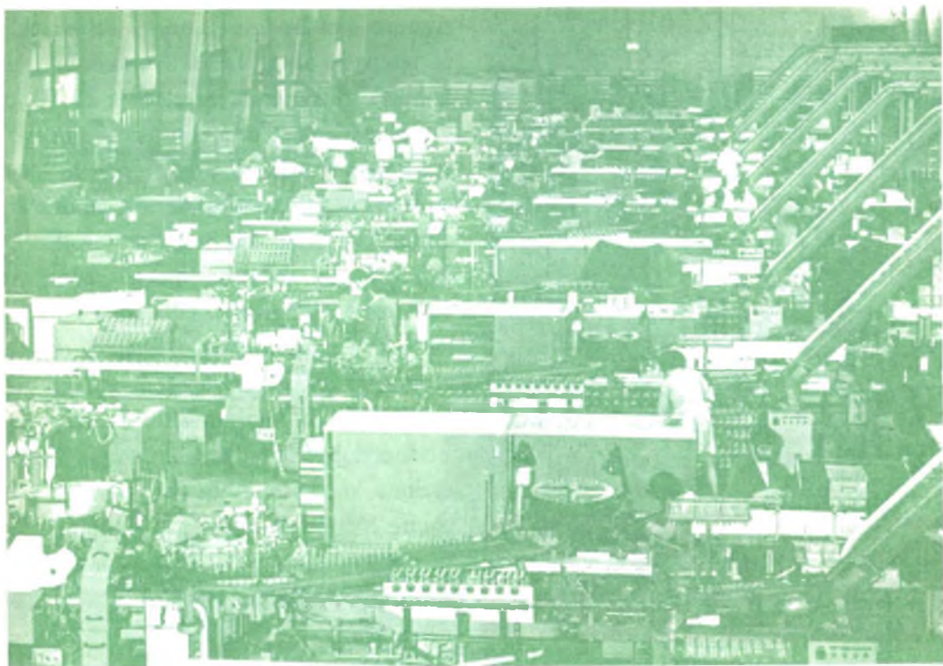
Fig. 2 - Sala Lampade del nuovo complesso industriale Philips "Alpignano 2°" in questo reparto ogni fase di lavorazione delle lampade è altamente automatizzata. (Documentazione Philips)
