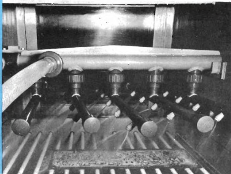
Fig. 6 - Illustrazione del moto alternativo adottato per la spruzzatura di un pannello a circuiti stampati.
