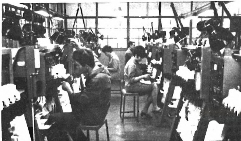
Fig. 1 - Reparto Trafileria Filamenti dello Stabilimento Philips in cui si avvolgono a spirale i fili di tungsteno ad una velocità media di 10.000 giri al minuto.
