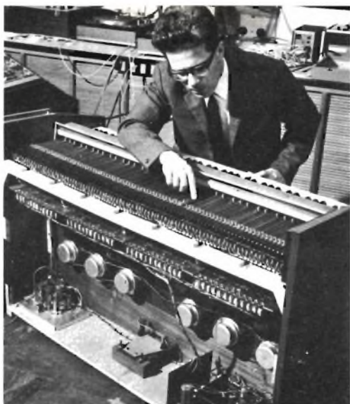
Fig. 3 - Vista interna del pianoforte elettronico. (Documentazione Philips)
