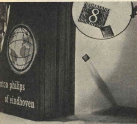
Fig. 2 - Con il processo P-D messo a punto dalla Philips si possono ottenere facilmente immagini fotografiche di grandezza pari a un quattrocentesimo dell'originale. (Docum. Philips)
