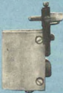
Fig. 4 - I due spinotti che si inseriscono direttamente nel misuratore devono essere tenuti fermi da due viti. Praticate i fori per dette viti in modo che essi vengano a trovarsi in posizione di angolo retto l'uno rispetto all'altro.
