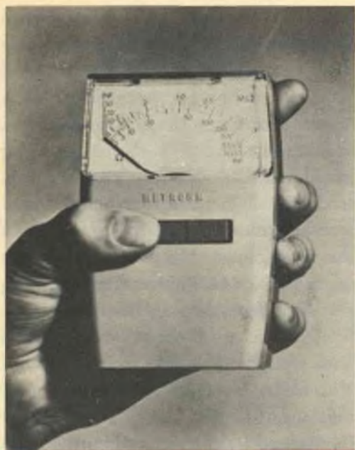
Fig. 3 - Questo misuratore di isolamento, denominato "Metrohm" e progettato di recente dalla ditta inglese Edcumbe Peebles Ltd, può anche servire quale misuratore di continuità a bassa impedenza e quale voltmetro per usi generali.
