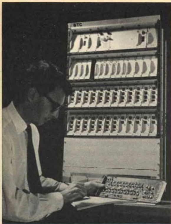
Fig. 2 - Un pannello per collegamenti destinato ad un calcolatore microelettronico viene controllato accuratamente da un esperto prima di essere sottoposto ad un unico processo di saldatura.
