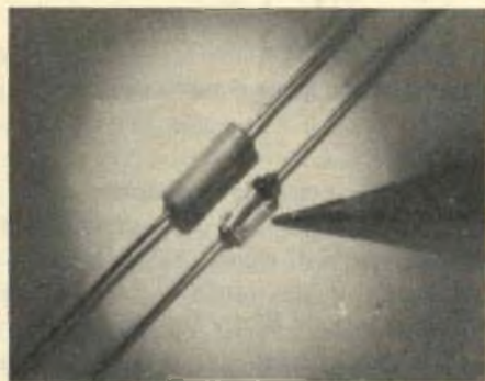
Fig. 3 - Come si vede in questa figura, le dimensioni del nuovo termistore a coefficiente positivo di temperatura della Texas Instruments, sono circa un terzo di quelle del tipo precedente, incapsulato nella consueta custodia resinosa.
