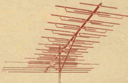
Quest'antenna VHF a quarantadue elementi, progettata in modo specifico per la ricezione TV a colori, misura 58 x 34 m e pesa 6,5 kg. Comprende quaranta elementi parassiti e due attivi, con una sola discesa. Gli elementi parassiti sono direttori e riflettori inseriti per ottenere una stretta caratteristica polare, un buon rapporto anteriore-posteriore ed un alto guadagno.
