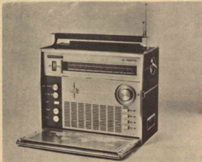
Ecco il ricevitore portatile Marco Polo prodotto dalla Perdio, dotato di diciassette transistori.
