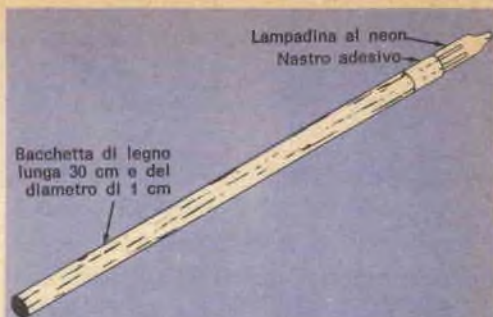
Fig. 2 - Montando una lampadina al neon su un'estremità di una bacchetta si può realizzare un indicatore di AT: la lampadina si accenderà avvicinandola ad un punto ad AT. La resistenza zavorra in questo caso non è necessaria.
