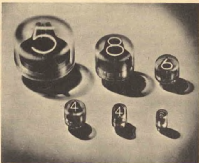
Fig. 9 - L'indicatore numerico Nixie produce un carattere illuminato con la formà del catodo. Il circuito relativo è riportato nella fig. 10.
