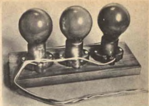
Fig. 10 - Per la prova dell'organo a colori costruite questo semplice sistema di presentazione. Basta montare tre portalampe su una base di legno ed avvitare in essi tre lampade da 25 W. Il sistema potrà poi anche essere utilizzato per un impianto molto più elaborato.
