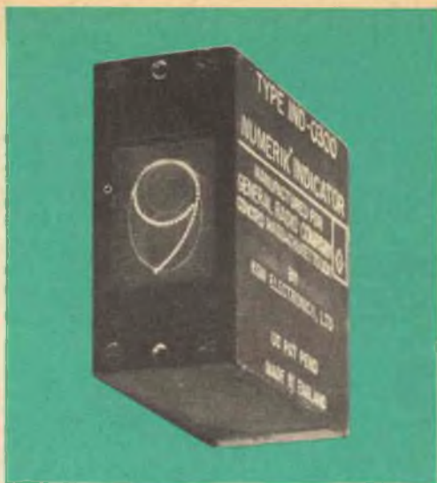
Fig. 12 - In questo tipo di indicatore a lettura diretta vi è una serie di strisce di plastica sovrapposte, la superficie delle quali ha la forma di numeri, che vengono illuminate di lato.
