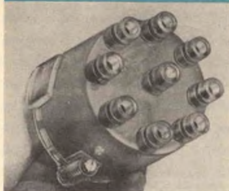
Alcuni cappucci di distributori non sopportano le tensioni più alte generate dalle bobine con rapporto più elevato e quindi per i sistemi dove le perdite di tensione rappresentano un problema, è stato progettato questo cappuccio trasparente.
