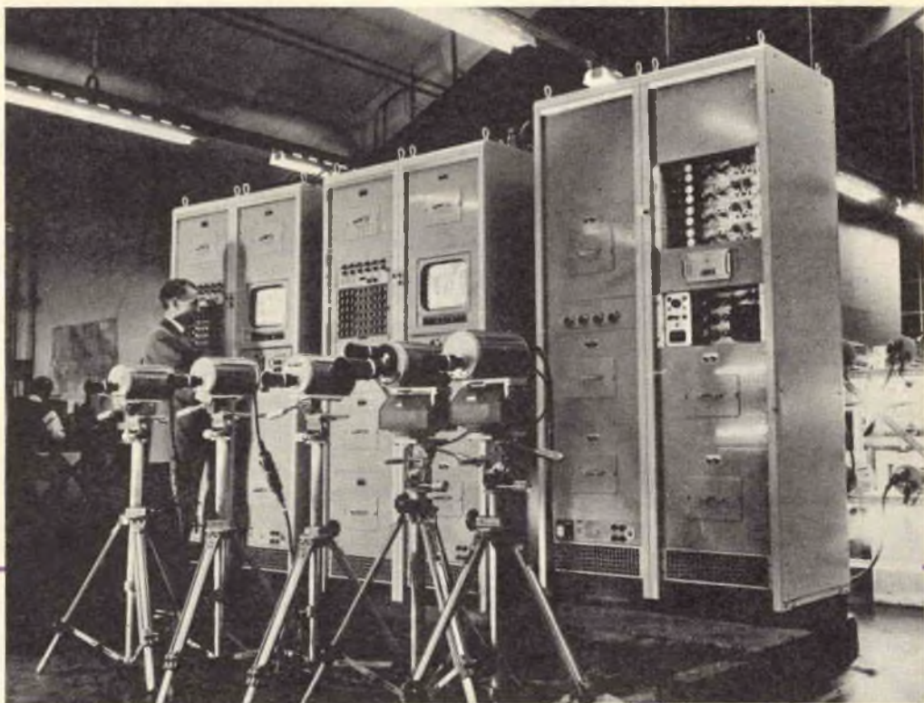
Nella centrale elettrica nucleare di Transfynydd, nel Galles, è stato installato uno dei più grandi sistemi di televisione a circuito chiuso. Fanno parte di questo complesso 58 telecamere che opereranno a distanza per facilitare il controllo della sommità della pila e dei due reattori. Il sistema, che comprende le cabine di controllo e sei carrelli televisivi con relativi schermi e pannelli di comando, è stato realizzato dal Gruppo PYE; si tratta di una delle più importanti ditte elettroniche inglesi.
