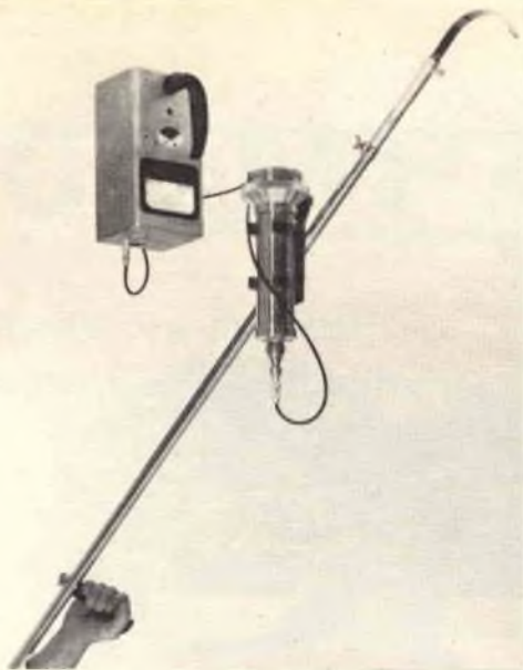
Fig. 3 - Lo strumento presentato è in grado di misurare lo iodio 131 al suolo, anche in presenza di altri isotopi di iodio e di prodotti della fissione.
