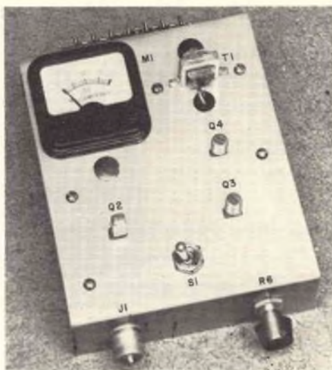
Nella foto, che rappresenta il trasmettitore completo, sono state segnate le sigle che contrassegnano i vari elementi perché risulti più chiaramente come gli stessi devono essere disposti.
