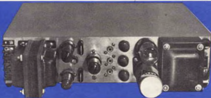
Lato giusto rivolto verso l'alto. Con la valvola raddrizzatrice ed i condensatori posti l'uno vicino all'altro, in questo amplificatore la temperatura del condensatore elettrolitico si stabilizza di solito a circa 38 °C entro mezz'ora.
