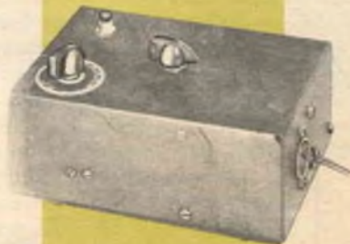
I controlli del temporizzatore sono montati sul lato superiore della scatola; R3 è munito di una scala graduata (cerchio bianco).
