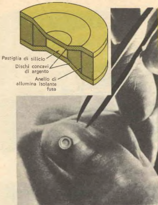
Fig. 2 - Sezione del nuovo diodo «sildisc» prodotto dalla Controls Company of America; in esso è stata adottata una nuova tecnica costruttiva che consente la massima dissipazione del calore malgrado le dimensioni ridottissime. La foto mostra uno di questi diodi.
