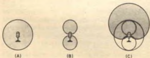
Fig. 6 - I diagrammi di sensibilità più comuni dei microfoni sono quelli omnidirezionale (A), bidirezionale (B), e unidirezionale o cardioide (C). Quando A e B vengono algebricamente addizionati, essi producono C.
