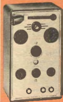
Fig. 1 - Un semplice provavacircuiti come quello rappresentato in figura è uno fra i tipi più semplici di provavalvole. Molto utile nella ricerca dei guasti, esso è munito di una lampada spia che si accende se i filamenti della valvola sotto prova sono in buone condizioni.
