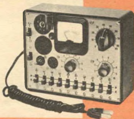
Fig. 2 - I cortocircuiti interni fra gli elementi di una valvola si possono rapidamente e facilmente individuare con un provavalvole del tipo illustrato. Per maggior semplicità e chiarezza questa parte del circuito elettrico del tester rappresenta solo uno zoccolo dell'unità.
