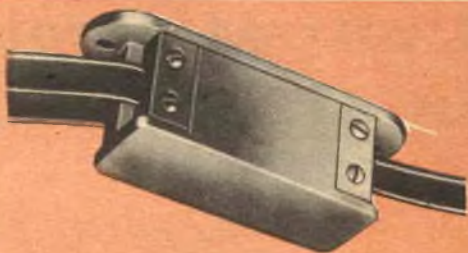
Accoppiatore per quattro televisori. Anche questo è a resistenze a ponte per aree a forte segnale. Si possono usare sino a quattro televisori oppure televisori e ricevitori MF con la medesima antenna.
