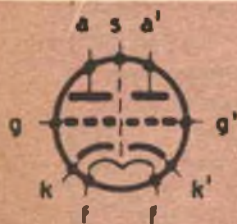
Schema e connessioni allo zoccolo del tubo ECC 85.
