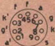
Schema e connessioni allo zoccolo del tubo ECC 85.
