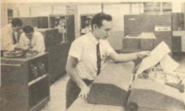
I dati forniti da una calcolatrice a nastro possono essere immessi direttamente in una macchina da stampa come la IBM 704 qui illustrata, usata anche per le prove sui missili.
