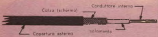
Costruzione di un cavo schermato semplice per il collegamento dei vari componenti.
