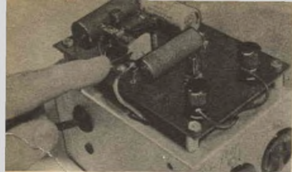
Il telaioetto minore deve essere montato su quello principale mediante supporti cilindrici isolanti.
