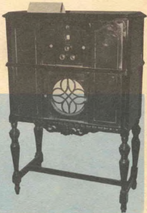
1926 Primo apparecchio radio completamente in alternata con i pezzi della radio compresi tutti in un mobile. Prezzo di vendita al pubblico di L. 2700.
