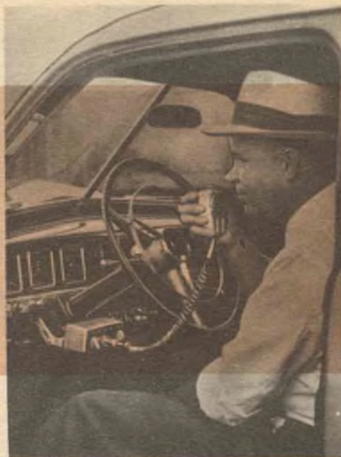
Installazione della RCA per sistema di comunicazioni radio bilaterali in una dilta di trasporti. - A sinistra: lo spedizioniere comunica con uno degli autocarri in sosta d'attesa per nuova destinazione.
