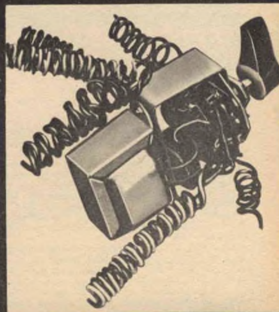
In questa foto si può notare come il trasformatore di entrata sia attaccato al commutatore mediante una striscia d'alluminio. Potrete sistemare la maggior parte dei fili prima di collocare il commutatore e il trasformatore.
