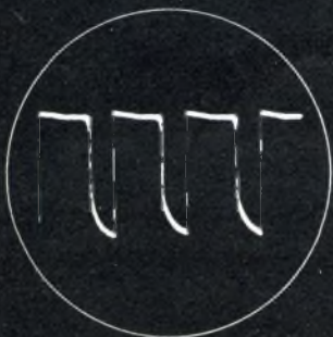
Fig. 4 - Forma d'onda del segnale generato dal cercaguasti.
