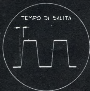
Fig. 1 - Onda di forma rettangolare.
