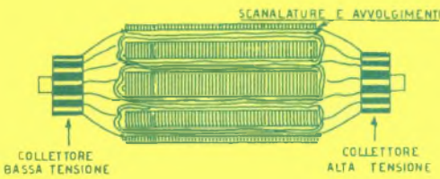
Fig. 3 - Indotto di survoltore rotante.
