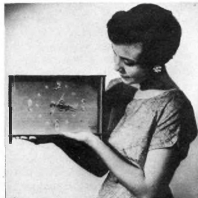
L'orologio senza carica è azionato da un motorino sincrono alimentato da un oscillatore a batteria a 60 Hz. La frequenza dell'oscillatore è sincronizzata con i 60 Hz della rete luce per mezzo di onde elettromagnetiche captate dall'antenna ed irradiate dai fili dell'impianto luce.
