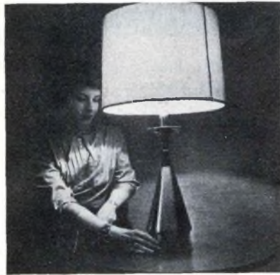
L'interruttore elettronico funziona quando si fa un ponticello con le dita fra le due parti di metallo della base della lampada. La mano fa diminuire la resistenza elettrica del circuito permettendo il passaggio di corrente nella valvola che a sua volta aziona il relè.
