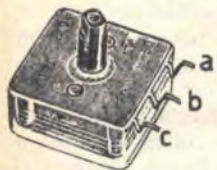
Fig. 5 - I terminali a c del condensatore variabile debbono essere collegati tra di loro.
