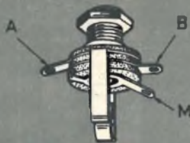
Fig. 4 - Il terminale M della spina jack rappresenta il terminale di massa. Nello schema pratico di figura 2 risulta utilizzato il terminale A; quindi rimane inutilizzato il terminale B. In pratica è assolutamente necessario il microfono alla spina jack (maschio) nelle posizioni corrispondenti ai terminali A e M.
