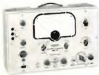
GENERATORE DI SEGNALI TV mod. 222 volutore - calibratore generatore di barre orizzontali
