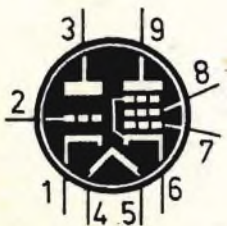
6CX8 TRIODO-PENTODO AMPL. B.F. (zoccolo noval)
