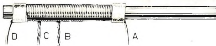
Fig. 5 - La bobina di sintonia è avvolta su nucleo di ferrite di forma cilindrica delle dimensioni di 8 x 140 mm.; i terminali dell'avvolgimento sono bloccati con due pezzetti di nastro adesivo.
