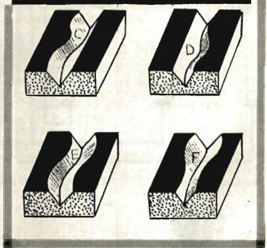
Fig. 7 - I sei disegni A-B-C-D-E-F illustrano il solco del disco stereofonico prima e dopo la modulazione. Solco monofonico non modulato (A); solco stereofonico non modulato (B); modulazione del solo canale sinistro (C); effetto del segnale del canale destro (D); modulazione di uguale intensità di entrambi i canali (E); modulazione di segnali di uguale intensità ma in opposizione di fase (F).
