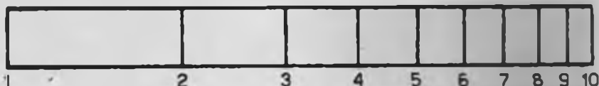
Fig. 2 - Il disegno sopra riportato è rappresentativo di una scala a suddivisione logaritmica: in essa i numeri sono sostituiti con i loro logaritmi, che permettono di sommare tra loro due numeri moltiplicandi e di sottrarli dividendelli.
