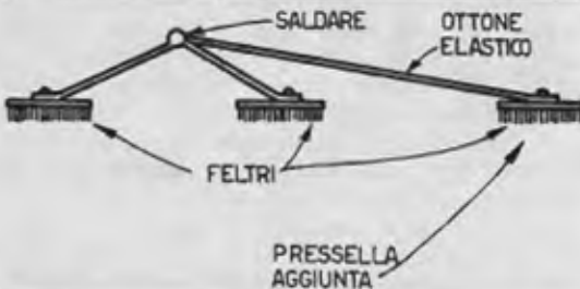
Fig. 4 - L'applicazione della terza testina magnetica per l'effetto eco impone l'aggiunta di una terza pressella di feltro sostenuta da un braccio ottenuto con un pozzetto di ottone elastico.
