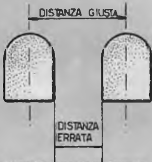
Fig. 5 - L'applicazione della formula, che permette di determinare la precisa distanza fra la testina di cancellazione e la testina eco, va fatta computando la distanza che intercorre fra le sezioni centrali delle due testine, così come indicato nel disegno.
